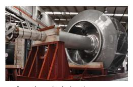
mediante el maquinado de rodetes en nuestro torno vertical con capacidad de 157 pulgadas de diámetro y manejo de peso hasta 70 mil libras, con ensambles interferidos el cuñero es una geometría crítica la cual aseguramos por medio de un equipo CNC.
